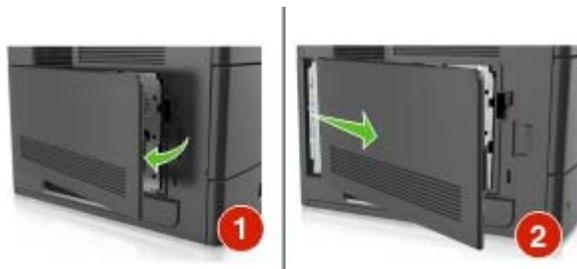
**2** A l'aide d'un tournevis, dévissez les vis de la plaque protectrice de la carte logique.
