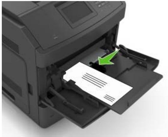
**Attention — Dommages potentiels :** n'utilisez jamais d'enveloppes avec timbre, agrafe, fermoir, fenêtre, revêtement intérieur couché ou bande autocollante. Ces enveloppes peuvent endommager sérieusement l'imprimante.
