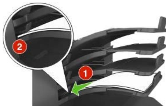
**Remarque :** Un bourrage se produit en raison d'une surcharge du réceptacle si le papier n'est pas placé sous le bras du réceptacle.
